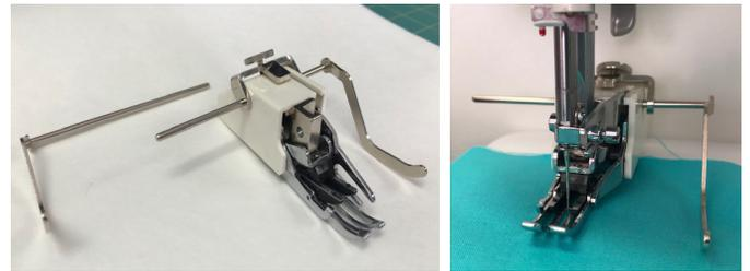
1. Placez la bride en forme de U sur le pied marcheur et alignez les trous de la bride.
