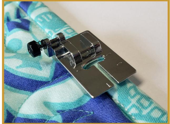
5. Sélectionnez un point de couture et ajuster la positionne de l'aiguille sur la gauche (Max. 7mm) en utilisant le réglage de position de l'aiguille. (Veuillez-vous referrer a votre manuel pour le réglage et position de l'aiguille).
