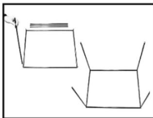
4. Compléter l'assemblage en ajoutant le cadre assemblé restant aux rails latéraux, en insérant de nouveau les chevilles à chaque coin dans les rails latéraux.
