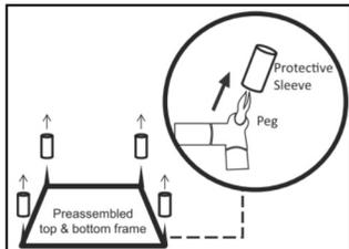
3. Insérez les quatre rails latéraux sur les chevilles au coin de chaque côté d'un cadre assemblé.
